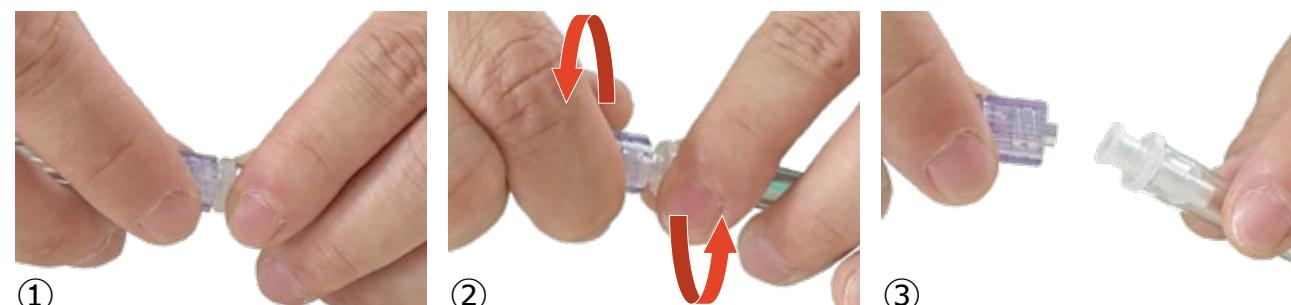
本体とポンプを取り付け、左図のポンプの○部分をねじりながら外します。その状態でしばらくおき、軽くもみほぐすと空気が入った状態になります。
